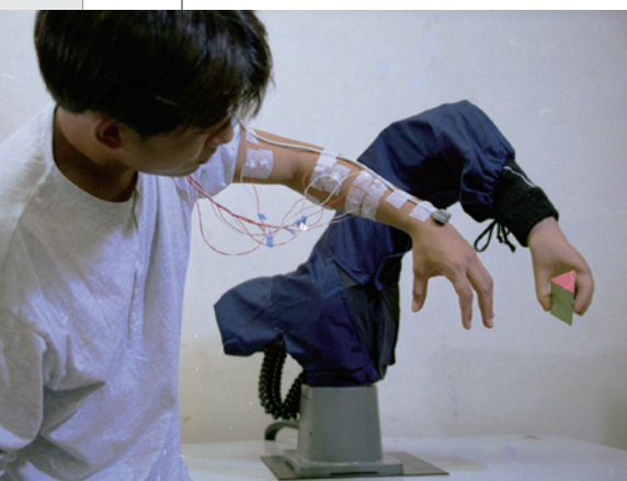
図1 義手型人間支援ロボット 計測した筋電位から操作者が意図する筋力、動作、関節の粘弾性を瞬時に読み取り、操作者の運動を再現します。手首関節を含むハンド部分を取り外して前腕切断者の身体に装着することができ、切断者の意図した運動を代行することが可能です。
